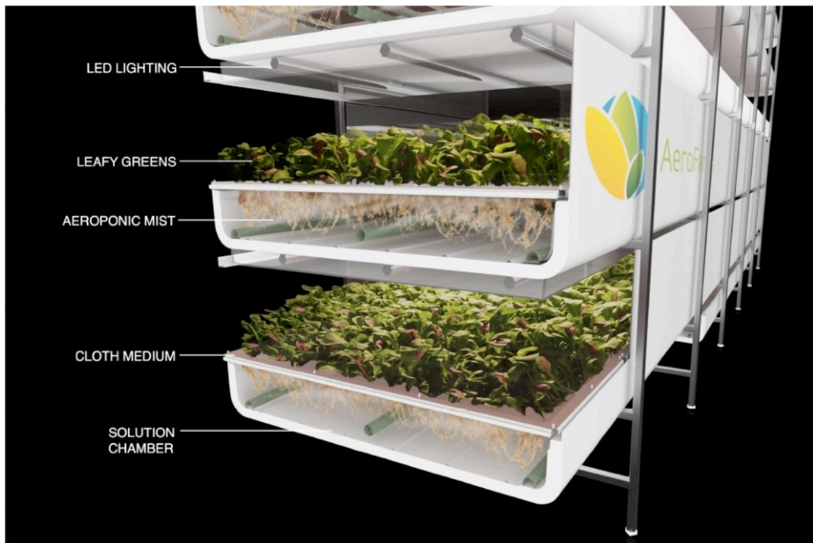
Fig 2 Coupe de principe d'une unité de culture de ferme verticale AeroFarm (Origine image extraite du site AeroFarm)
